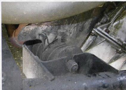
Ermüden die Motorlager, senkt sich das gesamte Triebwerk ab, was sich am...
