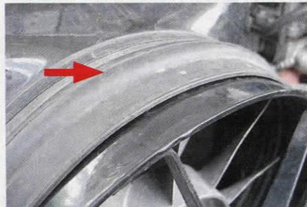
...Schlauch der Kühlerzarge zeigt. Der reißt irgendwann und gerät in den Ventilator
