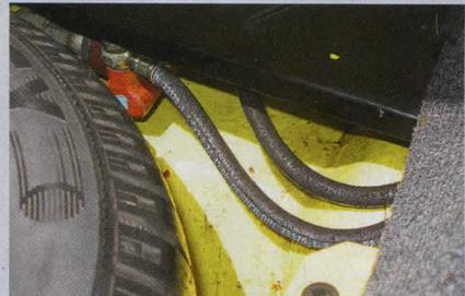
5 HBZ an der Spritzwand: Ausgetretene Bremsflüssigkeit nagt an Lack und Blech
