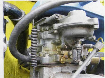
Ausgeschlagene Drosselklappenwellen sind dem Jikov-Vergaser fremd, gelockerte (unten)...
