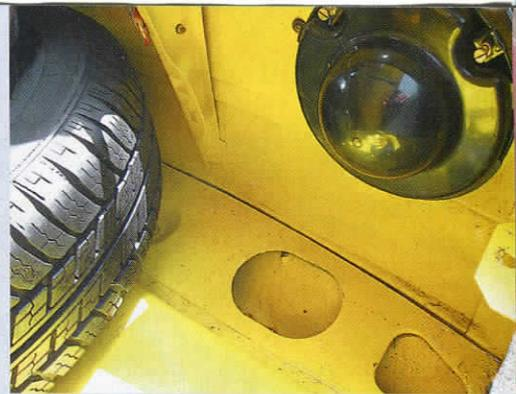
4 Feuchtigkeit im Kofferraum frisst an Frontmaske (rar) und Bodenblech
