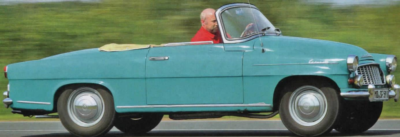
Škoda 440/445 beziehungsweise Octavia: Unter deren Ganzstahlkarosse versteckte sich ein Zentralrohrrahmen, vorn saß der Vierzylinder-Viertakter, per Vierganggetriebe wurde die Antriebskraft auf die Hinterachse übertragen, die als altväterliche Pendelachse an einer Querblattfeder daherkam. Zeitgemäßer war hingegen die Aufhängung der Vorderräder: Querlenker oben und unten, zunächst Querblattfeder,
