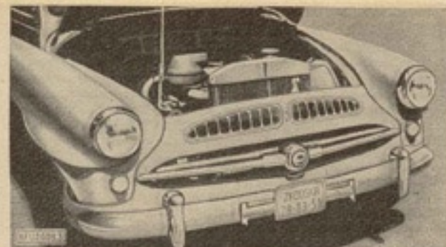
Bild 3. Als Antrieb des Spartak-Wagens dient ein wassergekühlter Vierzylinder-Viertakt-Motor. Nach dem Hochklappen der Haube ist der ganze Motor leicht zugänglich
